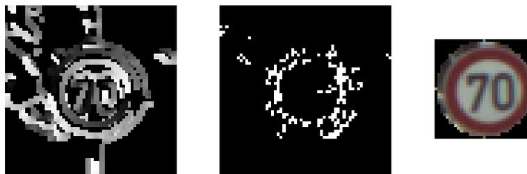
Figura 4.6: Imágenes del procedimiento de cálculo del radio. De izquierda a derecha: área recortada de la imagen de orientación del gradiente, máscara de los píxeles que serán utilizados para el cálculo del radio, y el área circular extraída de la imagen de entrada.
