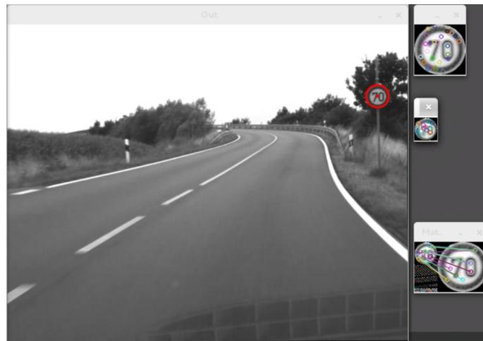
Figura 4.11: Comparación entre la imagen extraída y su correspondiente señal de tránsito de la base de datos. Izquierda: Imagen de entrada, con la región de interés extraída dibujada en rojo. Derecha: de arriba hacia abajo, template utilizado para las comparaciones con sus puntos clave marcados con círculos, región de interés extraída con sus puntos clave, y coincidencias encontradas entre el template y la región de interés extraída.
