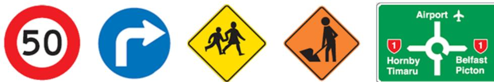
Figura 1.1: Ejemplos de señales de tránsito. De izquierda a derecha: señales obligatorias (primeras dos), señal de advertencia (permanente), señal de advertencia (temporal) y señal de información.
