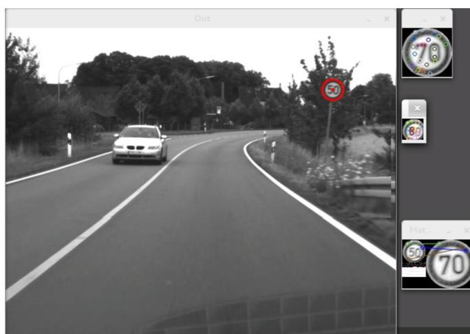
Figura 4.12: Comparación entre la imagen extraída y una señal de tránsito similar de la base de datos. Izquierda: Imagen de entrada, con la región de interés extraída dibujada en rojo. Derecha: de arriba hacia abajo, template utilizado para las comparaciones con sus puntos clave marcados con círculos, región de interés extraída con sus puntos clave, y coincidencias encontradas entre el template y la región de interés extraída.
