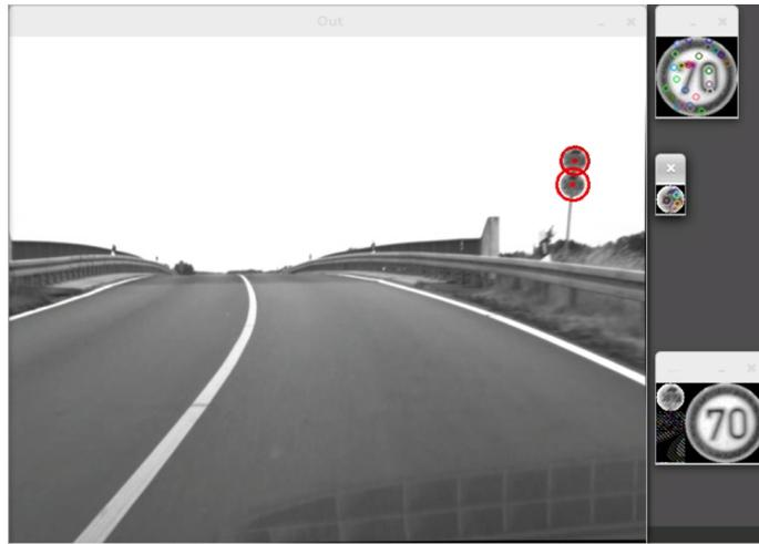
Figura 4.13: Comparación entre la imagen extraída y una señal de tránsito diferente de la base de datos. Izquierda: Imagen de entrada, con la región de interés extraída dibujada en rojo. Derecha: de arriba hacia abajo, template utilizado para las comparaciones con sus puntos clave marcados con círculos, región de interés extraída con sus puntos clave, y coincidencias encontradas entre el template y la región de interés extraída.
