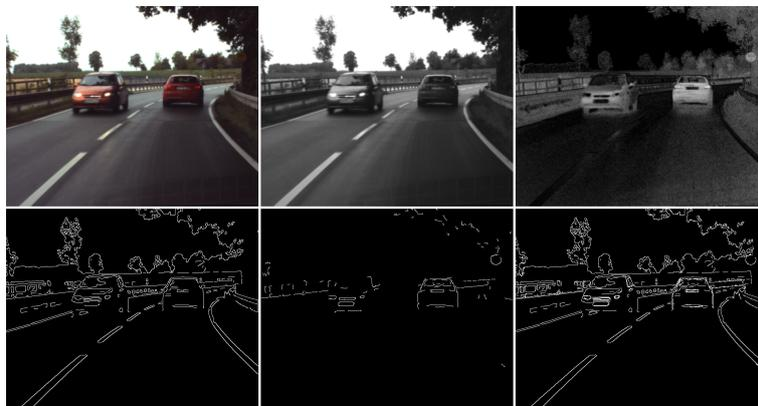
Figura 4.4: Imágenes de la etapa de detección de bordes, con imágenes a color como entrada. De izquierda a derecha y de arriba hacia abajo: imagen de entrada a color, imagen en escala de grises, canal de saturación, bordes extraídos utilizando la imagen en escala de grises, bordes extraídos utilizando el canal de saturación, y las dos imágenes de bordes fusionadas en una sola.
