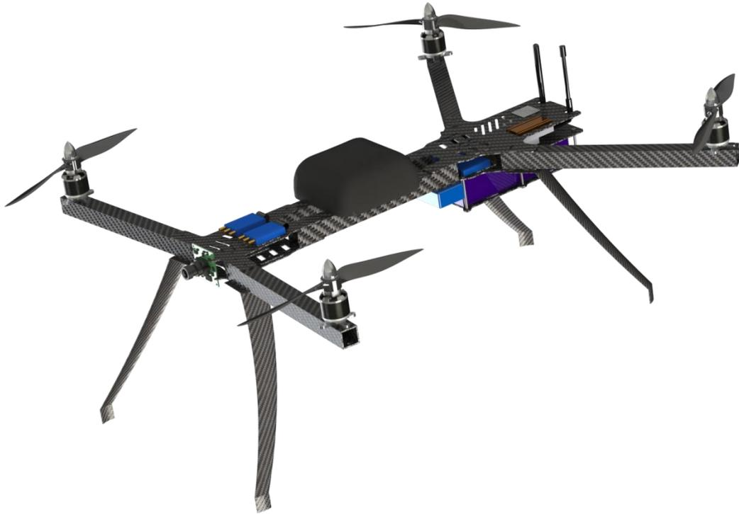
Siguiendo la línea de la plataforma GOINGPRO se decidió realizar una nueva plataforma GOINGPRO V2 la cual cuenta con numerosas mejoras en su funcionalidad. Como la inclusión de MotorMount que nos brinda la posibilidad de realizar un cambio rápido de motores ya que este sistema abraza al bastidor de aluminio a diferencia de la versión anterior que necesitaba tornillos pasantes para la sujeción que además debilitaba la estructura.
