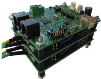
Consiste en una placa de control basado en un  $\mu C$  de arquitectura ARM7 de 32bits, y drivers tipo puente H para la excitación de cada uno de los motores de tracción.
