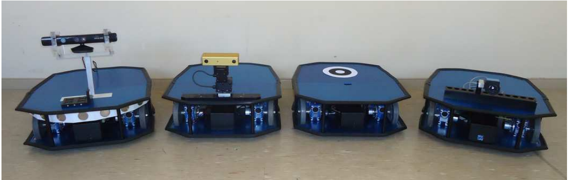
Figura 15: Robots móviles RoMAA-II disponibles en el CIH con diferentes sensores abordo. El primero de la izquierda cuenta con el anillo de ultrasonido.
