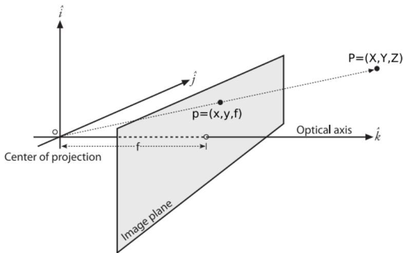
Un punto  $\mathbf{P} = (X, Y, Z)$  se proyecta en el plano de la imagen por medio de un rayo que pasa por el centro de proyección, y resulta en un punto imagen  $\mathbf{p} = (x, y, f)$
