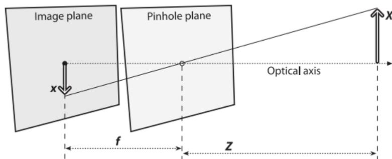
El modelo mas simple de una cámara comprende una apertura pinhole y un plano imagen. Cualquier rayo de luz que se emite o refleja por una superficie en la escena pasa a través de la apertura antes de alcanzar el plano imagen.
