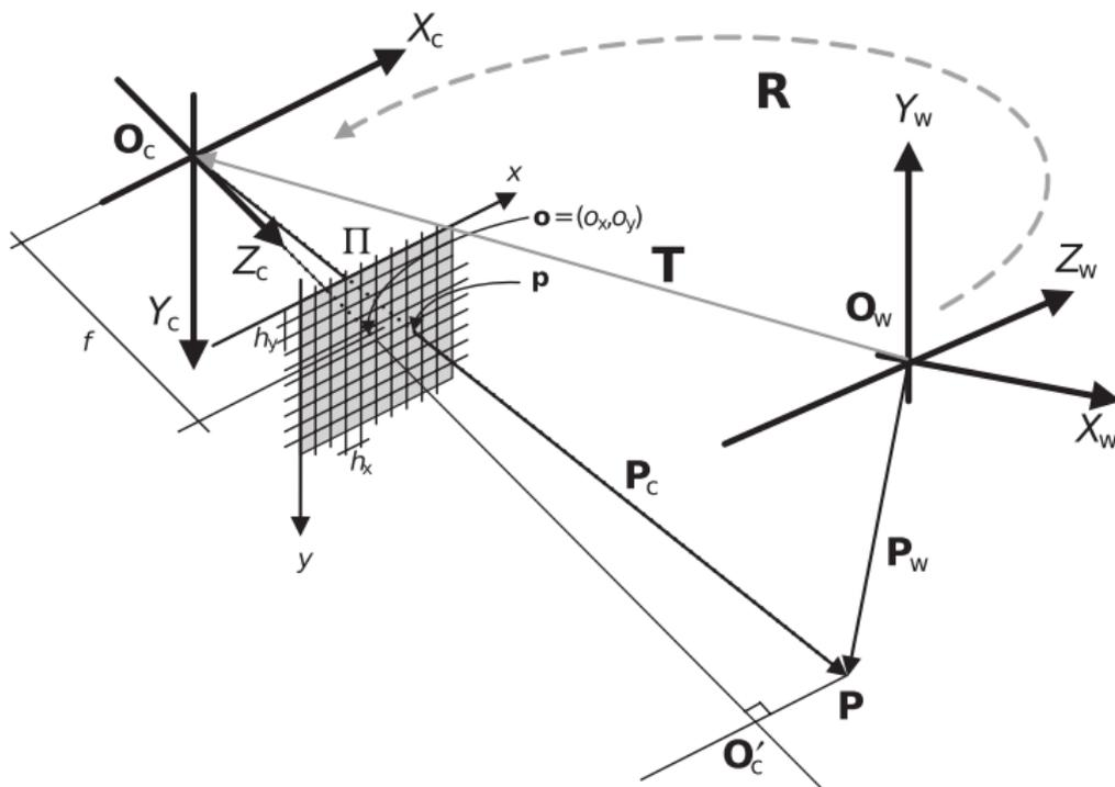
Figura: Modelo pinhole de una cámara perspectiva
